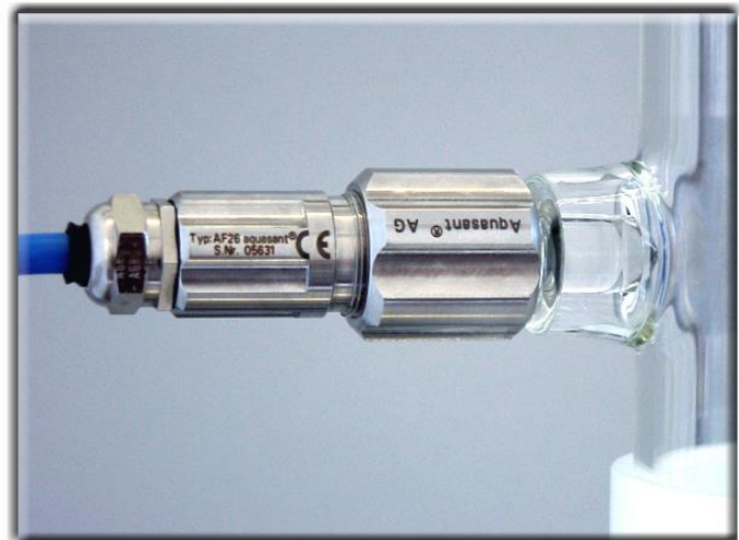
AF 26 IR-Detektor auf den Glasfühler vorsichtig aufschieben und Klemmverschraubung leicht anziehen
