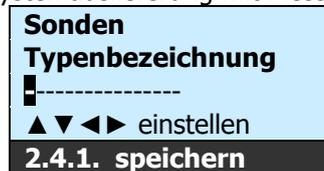
1. Mit den ▲▼◀▶-Tasten wird die alphanumerische Typenbezeichnung der Sonde eingegeben
