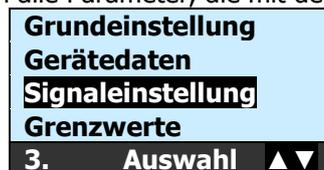
Nach Drücken der **ok**-Taste wechselt die Anzeige in das Untermenü Signaleinstellung
