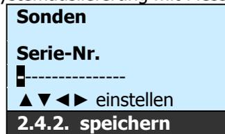
1. Mit den ▲▼◀▶-Tasten wird die alphanumerische Seriennummer der Sonde eingegeben
