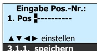
1. Mit den ▲▼◀▶-Tasten wird die alphanumerische Positionsnummer eingegeben
