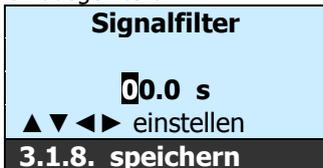
1. Mit den ▲▼◀▶-Tasten wird die Signalfilterzeit definiert
