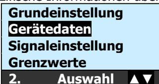
Nach Drücken der **ok**-Taste wechselt die Anzeige in das Untermenu Gerätedaten
