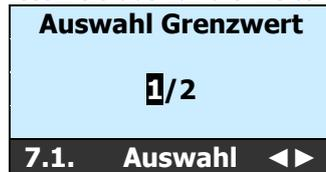
Nach Drücken der **ok**-Taste wechselt die Anzeige in das Menu des angewählten Messkreises (1). 7.1.3.
