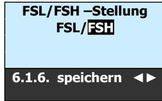
1. Mit den ◀▶-Tasten wird der Optokoppler-Ausgang definiert
