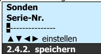
1. Mit den ▲▼◀▶-Tasten wird die alphanumerische Seriennummer der Sonde eingegeben
