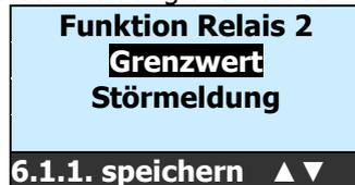
1. Mit ▲▼-Tasten wird die Relaisfunktion K2 definiert
