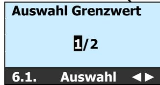
1. Mit den ◀▶-Tasten wird das Ausgangsrelais oder Transistor Optokoppler-Transistorausgang (NPN) 1 oder 2 definiert
