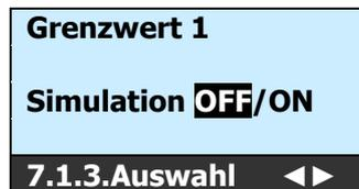
1. Mit den ▲▼◀▶-Tasten wird das Ausgangsrelais oder Transistor Optokoppler-Transistorausgang (NPN) 1 oder 2 umgeschaltet
